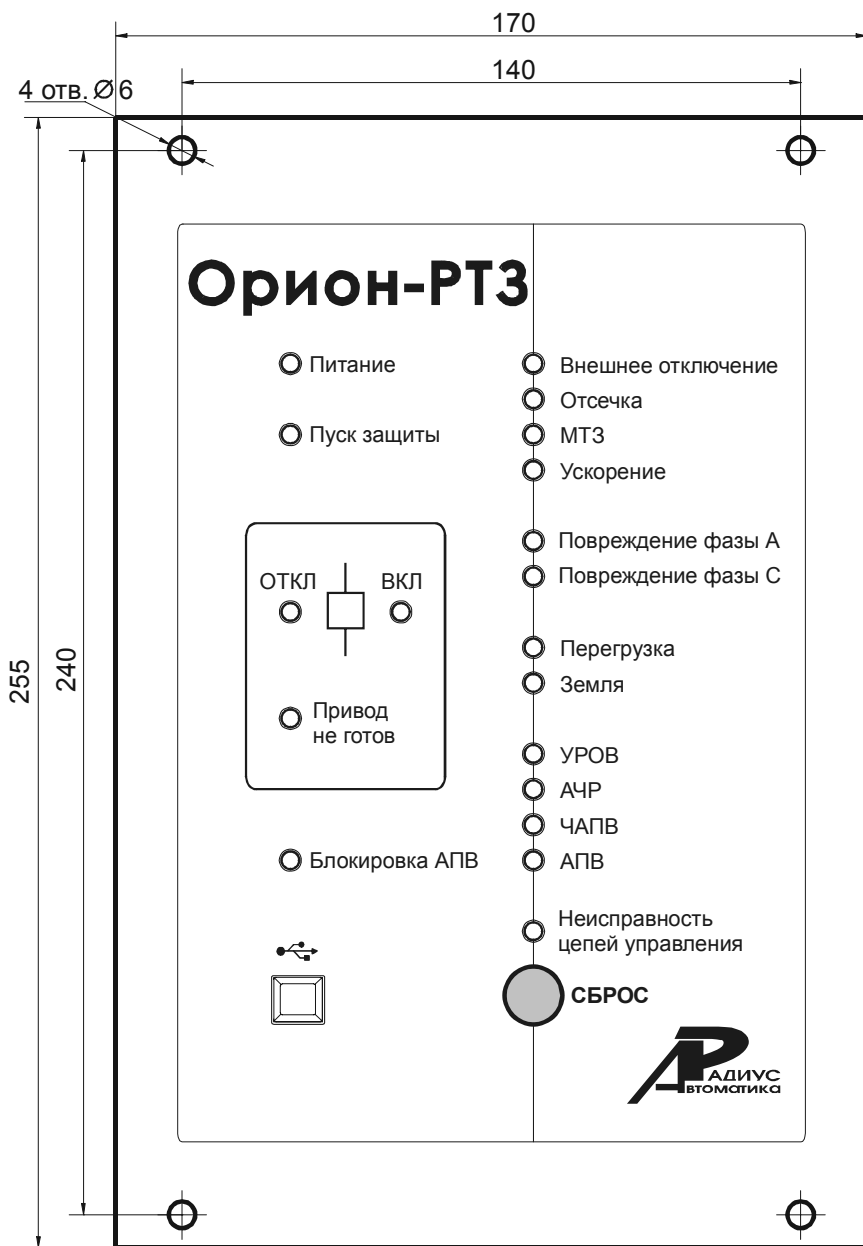
Рис. 8а Вид передней панели устройства (заднее присоединение)
