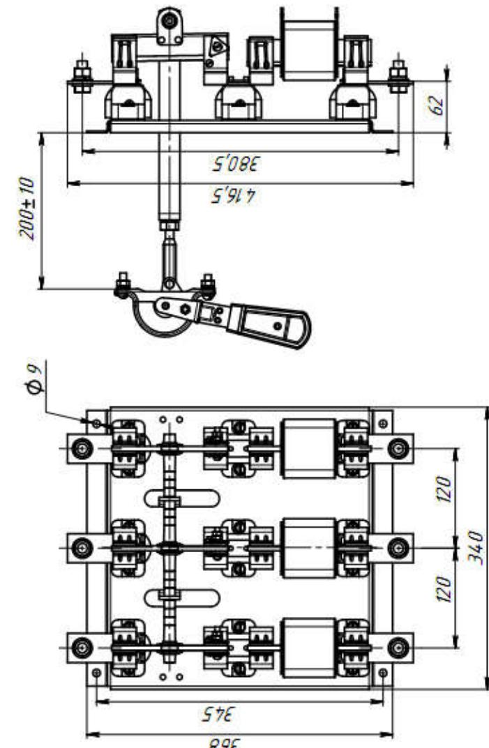
Рис.6Б Разъединители-предохранители с центральным приводом на ток 630 А масса, не более – 10,5 кг.
