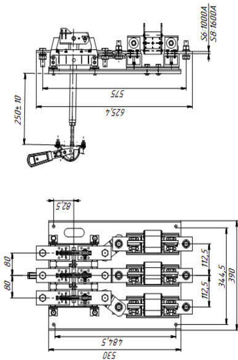
Рис. 7Б Разъединители-предохранители с центральным приводом на токи 1000 А и 1600 А
