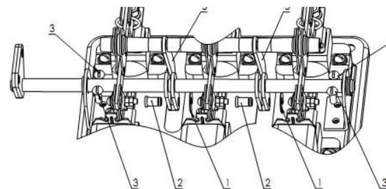
5. Закрепить подшипники на панели при помощи винтов поз.3;
