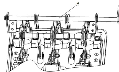
4. Снять вал поз.4 и развернуть его на  $180^{\circ}$ .
