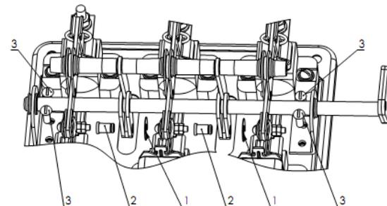
1. Снять стопорные шайбы поз.1
