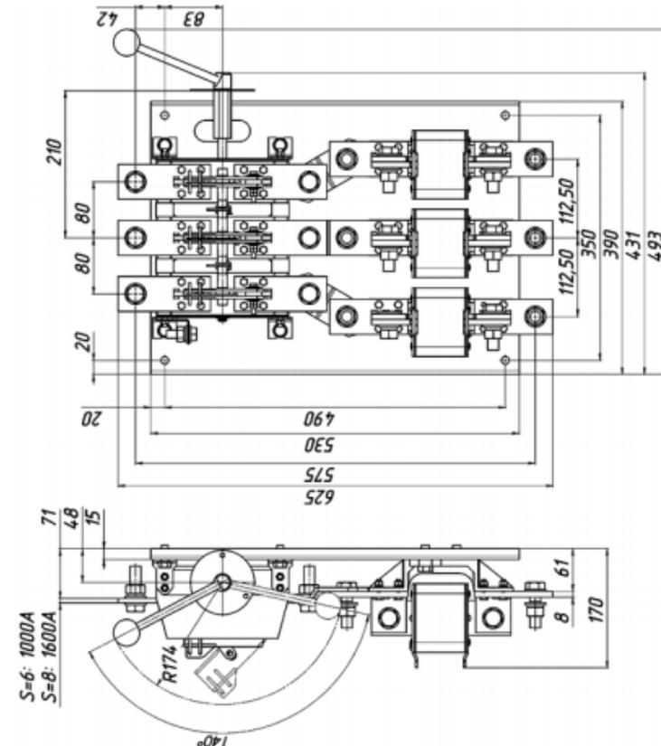
Рис.4Б Разъединители-предохранители с боковой смещенной рукояткой на токи 1000 А и 1600 А масса, не более: РПБ-10 – 26,35 кг; РПБ-16 – 29,3 кг.
