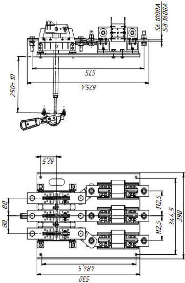
Рис. 7Б Разъединители-предохранители с центральным приводом на токи 1000 А и 1600 А масса, не более: РПЦ-10 – 26,35 кг; РПЦ-16 – 29,3 кг.
