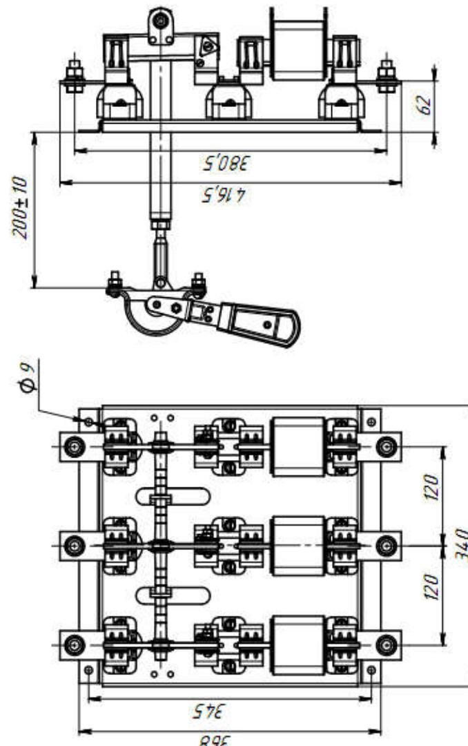
Рис.6Б Разъединители-предохранители с центральным приводом на ток 630 А
