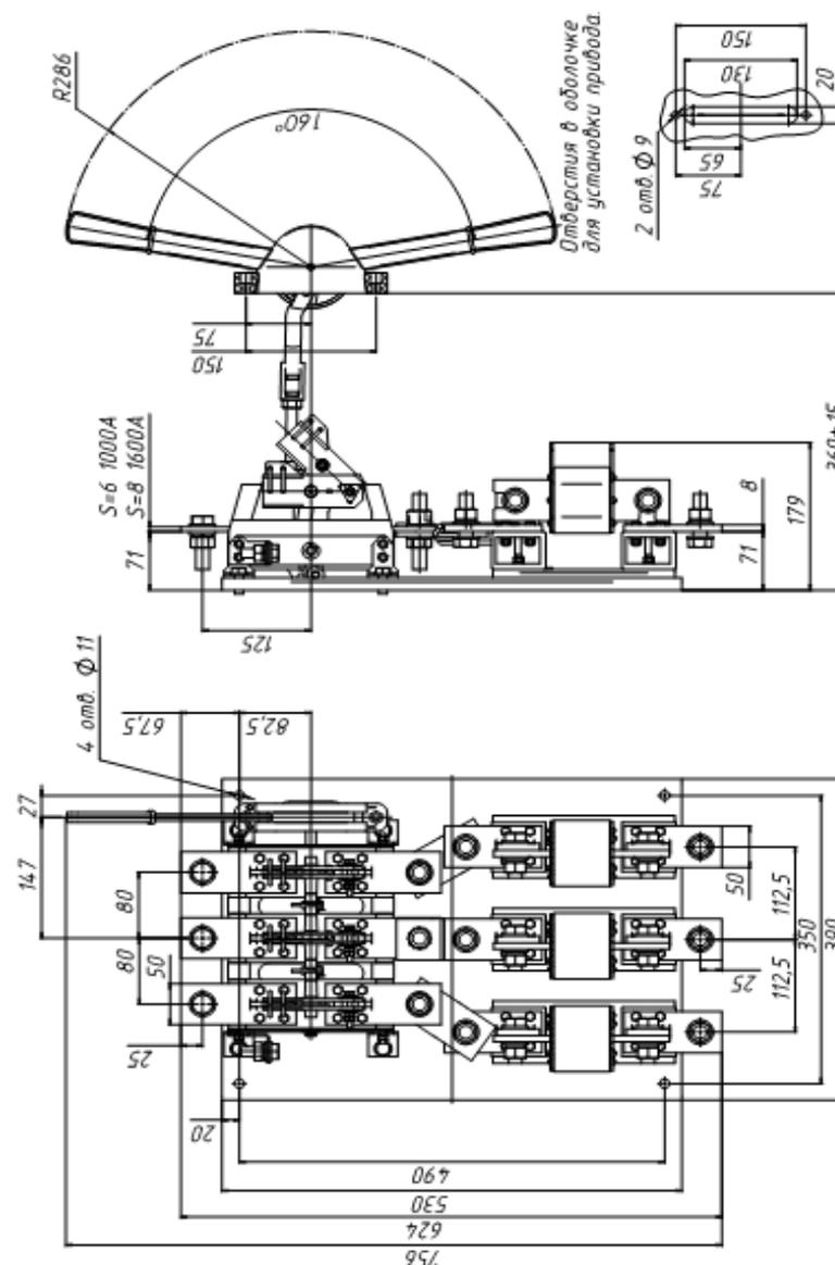
Рис. 2Б Разъединители-предохранители с передней смещенной рукояткой на токи 1000 и 1600 А масса, не более: РПС-10 – 26,35 кг; РПС-16 – 29,3 кг.
