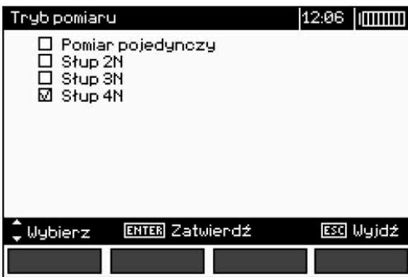
г) При выборе опоры с 4-мя ногами появится следующий экран. Если клещи были подключены к адаптеру EPR-1, а тот соединен с измерителем и задано количество оборотов и тип клещей, то на экране с правой стороны дисплея отображаются значения:  $U_N$  – напряжение помехи,  $f_N$  – частота помехи и  $I_L$  – ток утечки:
