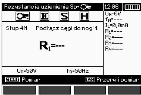
е) Этот экран появится через 5 секунд после появления вычисленного значения  $R_1$ , а затем отображается экран следующего измерения. Можно вызвать результат последнего измерения с помощью клавиши **ENTER** (результат 1-го измерения вернется на 5 секунд).
