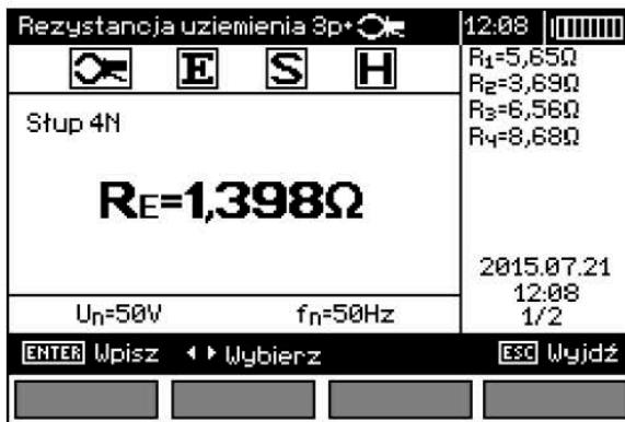
После выполнения всей серии измерений (на каждой ноге столба ЛЭП) отображается итоговый результат сопротивления заземления  $R_E$ . С помощью клавиш  $\blacktriangleleft$  и  $\triangleright$  можно изменять на дисплее результаты, отображаемые в рамке с правой стороны экрана.
