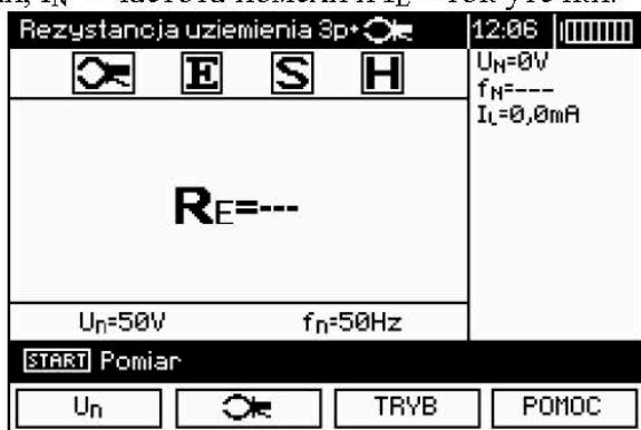
д) Нажатие клавиши **START** вызывает переход к следующему экрану. В соответствии с указаниями на экране, если это не сделано раньше, следует замкнуть клещи на первой ноге опоры ЛЭП. Измерение начнется после повторного нажатия на клавишу **START**.
