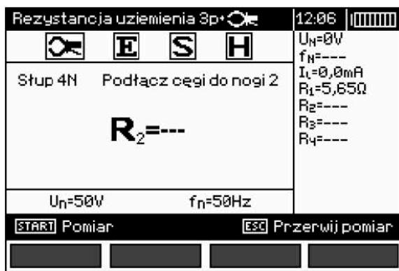
ж) После измерения сопротивления заземления на последней ноге опоры ЛЭП и после отображения в течение 5 секунд результата сопротивления R4 появится следующий экран:
