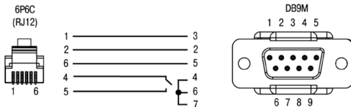
Рисунок В.2 - Схема кабеля КС3 для подключения модема к ПЛК100 по интерфейсу RS-232
