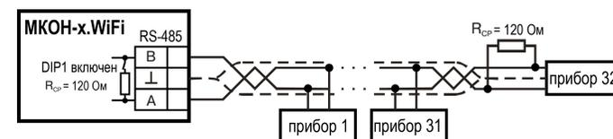
Рисунок 2 – Схема подключения
