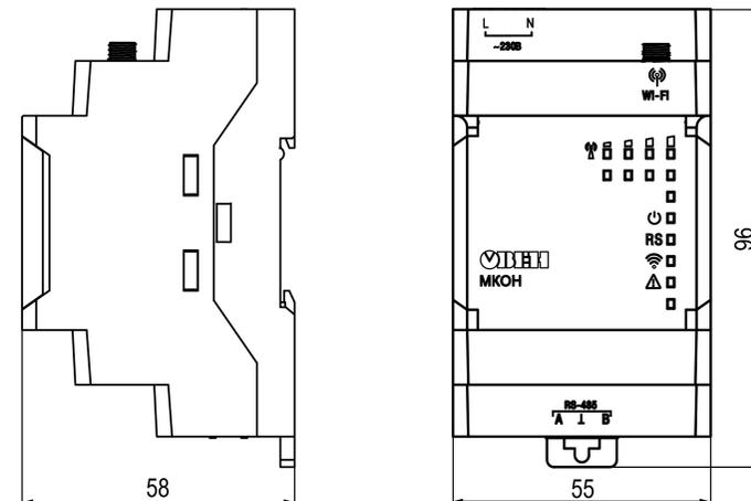
Рисунок 1 – Габаритные размеры
