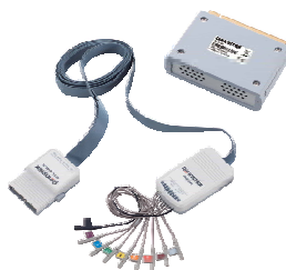
DS2-08LA Логический анализатор 8 каналов
