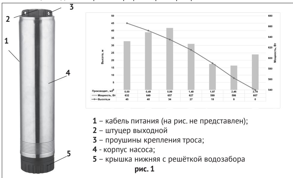
2.5 Двигатель (в герметичном кожухе) и насос расположены в нержавеющем корпусе (рис.1 поз.4). Насос приводится в действие однофазным асинхронным двигателем переменного тока. Подключение насоса к сети осуществляется кабелем питания (рис.1 поз.1) со штепсельной вилкой с заземляющим контактом. Насос начинает работу при подключении к сети питания.
