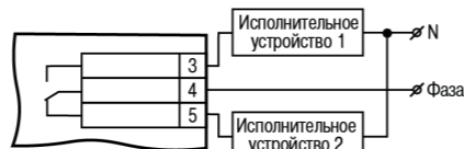
Рисунок 15 – Схема подключения нагрузки к ВУ типа Р
