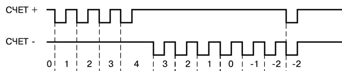
Рисунок 6.2 – Принцип работы входов «Счет+» и «Счет-»
