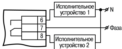
Рисунок 5.7 – Схема подключения нагрузки к ВУ типа «Р»
