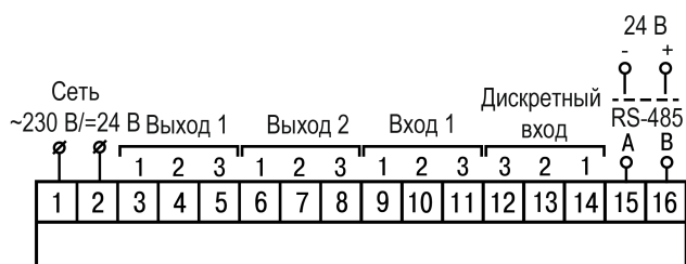
Рисунок 5.7 – Общая схема подключения TRM10–Н
