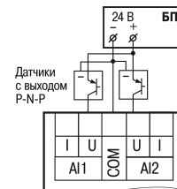
Рисунок 7 – Схема подключения к универсальным входам, работающим в дискретном режиме трехпроводных дискретных датчиков, имеющих выходной транзистор р-п-р-типа с открытым коллектором
