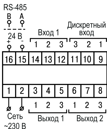
Рисунок 5.5 – Общая схема подключения ТРМ10–Ц5
