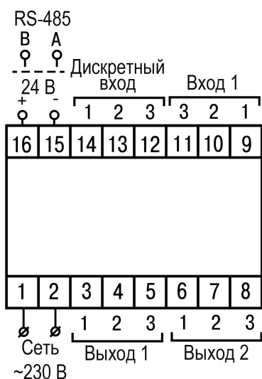
Рисунок 5.6 – Общая схема подключения ТРМ10–Д
