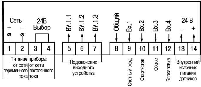
Рисунок 9 – Назначение контактов клеммника
