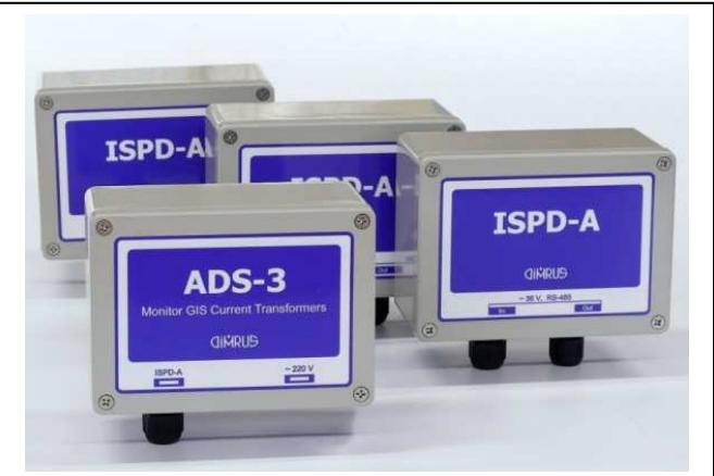
Питание базового модуля осуществляется от напряжения ~220В. Для питания датчиков ISPD-A используется переменное напряжение ~36В от трансформатора в базовом модуле. Это позволяет синхронизировать в датчиках процесс измерения частичных разрядов с фазой синусоиды питающей сети, что необходимо для выявления типа дефекта в изоляции и оценки его опасности.
