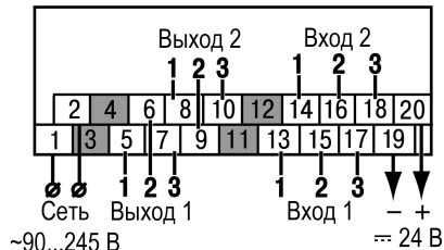
Рисунок 5.3 – Назначение контактов клеммной колодки прибора в корпусе Щ11
