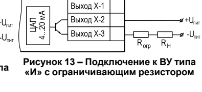
Рисунок 13 – Подключение к ВУ типа «И» с ограничивающим резистором
