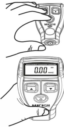
На этом калибровка закончена. Включите прибор кнопкой **СБРОС/()** и можно измерять толщину покрытий на том основании, на котором проводилась калибровка.
