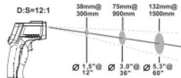
зависимости от размера измеряемого объекта выбирайте расстояние до него.
