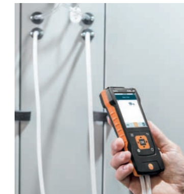
Модель testo 440 dP, включающая сенсор диф. давления
