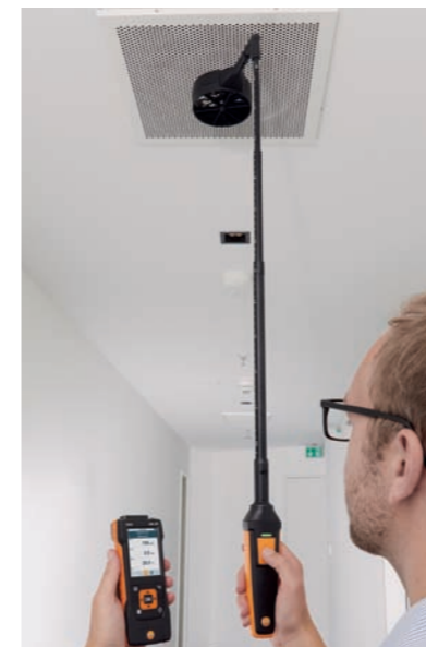
Модель testo 440 dP, включающая сенсор диф. давления
