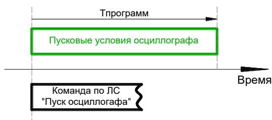
Рисунок 39 – Пусковые условия осциллографа при получении команды «Пуск осциллографа»
