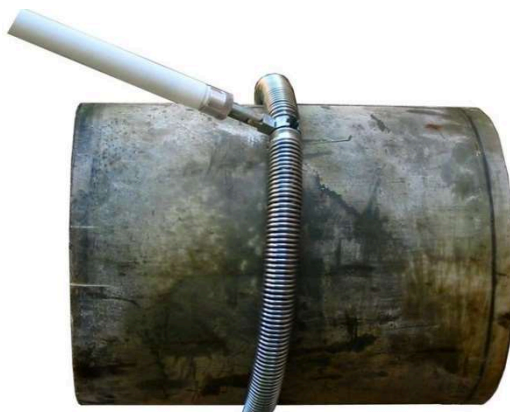
Рис. 27. Подготовленный к проведению контроля пружинный электрод с подсоединенными захватом и удлинителем
