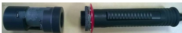
Рис.33. Вид высоковольтного трансформатора-держателя в разобранном виде:
