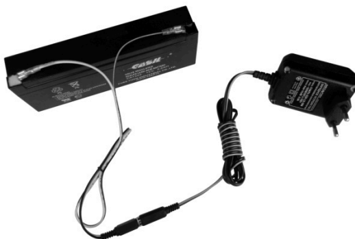
Рис. 30. Внешний заряд аккумулятора: подсоединение к переходному разъему на кабеле зарядного устройства соединительного кабеля с клеммами для подключения к аккумулятору и подсоединение клемм кабеля зарядного устройства к выводам аккумулятора
