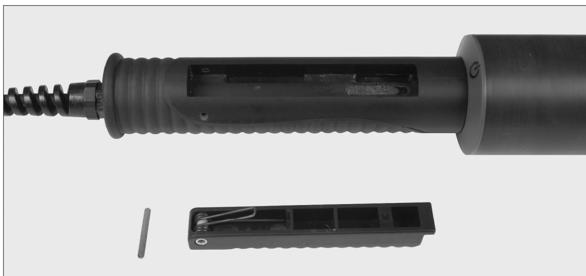
Рис.32. Последовательность действий при снятии кнопки включения:
