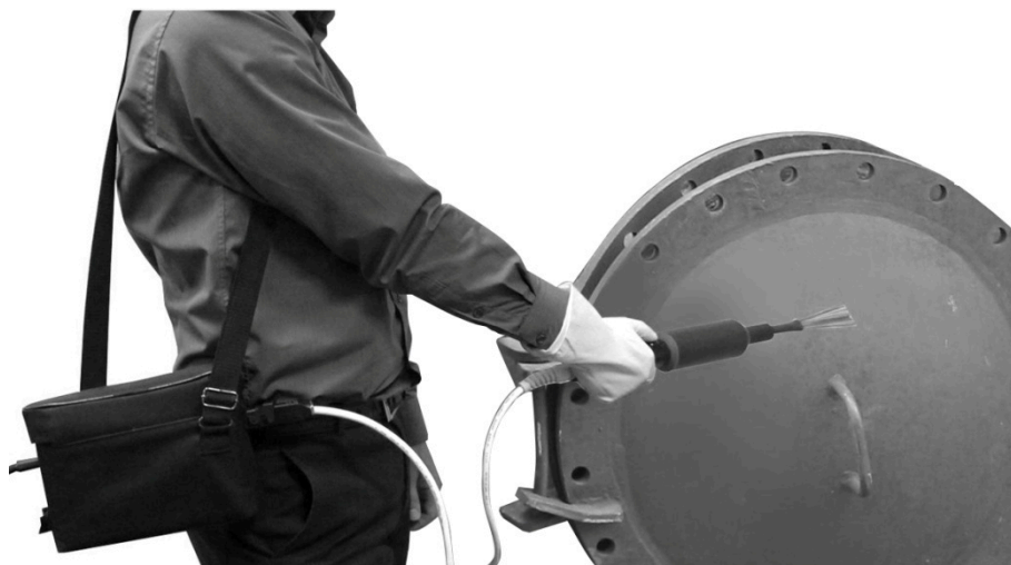
Рис. 22. Положение прибора при проведении контроля
