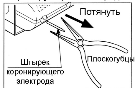
Рис.5 Замена штырька коронирующего электрода
