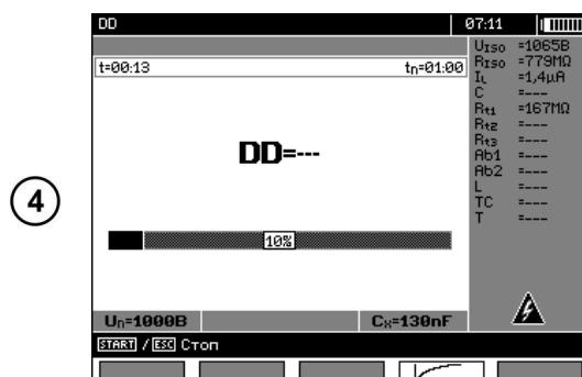
Как во время измерения, так и после его завершения существует возможность переключения между экраном с результатами и экраном с графиком с помощью клавиши **F4** .
