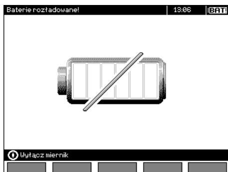
Аккумулятор разряжен, все измерения блокируются.
