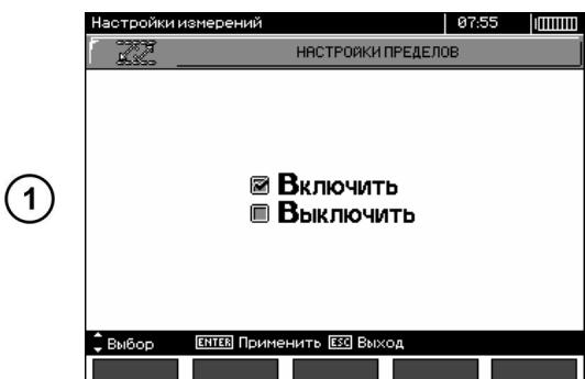
Клавишами выберите функцию включения или отключения пределов измерения.
