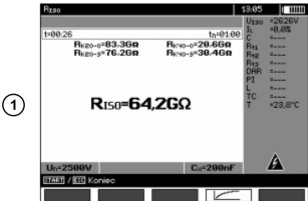
Чтобы выполнить ручную настройку, выберите F1 **Cx / T** и F5 **T**, а затем введите значение температуры. В случае, при подключении температурного зонда ST-1, в поле отображается измеренное значение.
