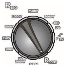
Установите поворотный переключатель выбора функций в положение **R<sub>CONT</sub>**.
