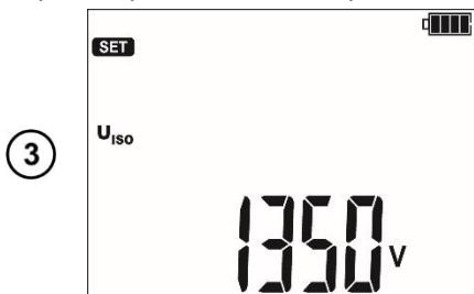
Измерительное напряжение **U<sub>Iso</sub>**.
