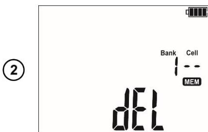
Задайте номер **Bank** для очистки клавишами **←** и **→**. Установите номер ячейки **Cell** на «--».
