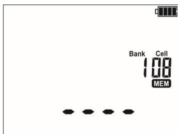
После выполнения измерения нажмите клавишу **ENTER**, прибор переходит в режим записи в память.
