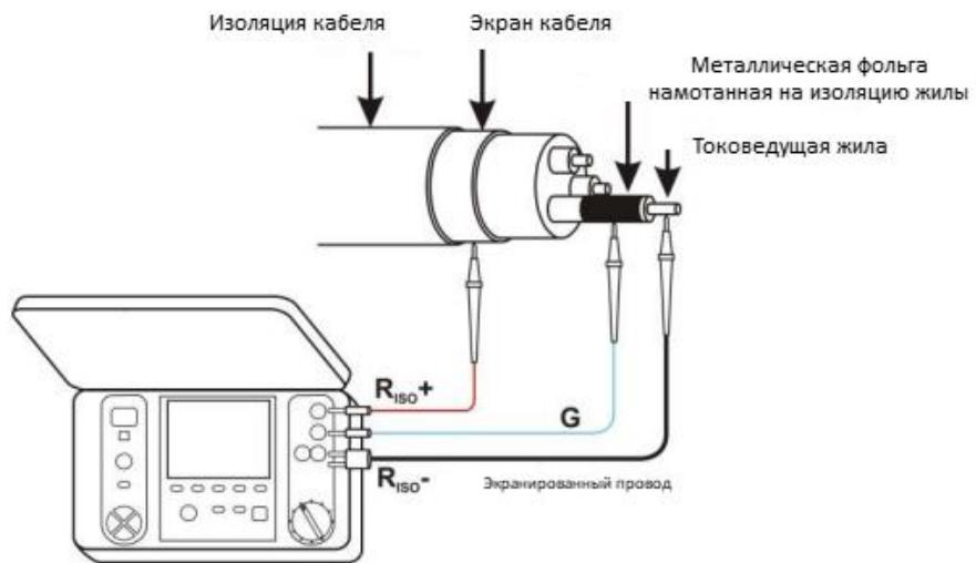
Так же поступают при измерении сопротивления изоляции между двумя жилами кабеля, присоединяя к разъему **G** остальные жилы, не участвующие в измерении.
