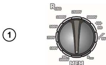
① Установите поворотный переключатель выбора функций в положение **MEM** и нажмите на клавишу **MENU**.
