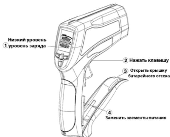
При низком уровне зарядки элементов питания, на дисплее отобразится символ
