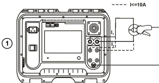
Необходимо замкнуть между собой оба токовых гнезда, охватить клещами этот провод и нажать кнопку **СТАРТ/СТОП**. При калибровке клещей ток всегда меньше 10 А, поэтому можно использовать гнёзда 10 А или 100 А (200 А).
