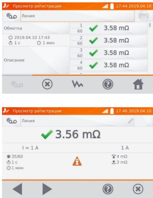
В случае **Регистрации**, нажатие поля с результатом вызовет отображение отдельных измерений с возможностью их прокрутки с помощью кнопок
