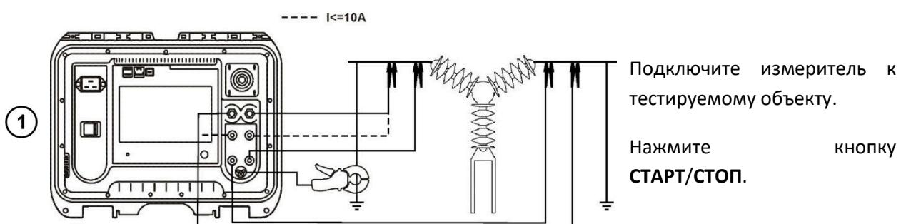
(2) Кроме измеренного сопротивления, измеритель также отображает значение тока, измеренного клещами.
