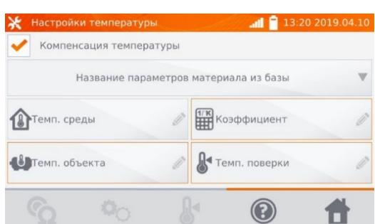
После отметки поля **Компенсация температуры**, измеритель рассчитывает на основе введённых температур и температурного коэффициента сопротивления, значение сопротивления для заданной температуры.
