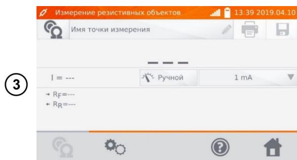
Переключение типа регулирования измерительного тока Авто/Ручной
