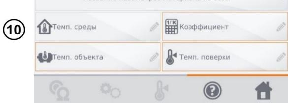
После отметки поля **Компенсация температуры**, измеритель рассчитывает на основе введённых температур и температурного коэффициента сопротивления, значение сопротивления для заданной температуры.
