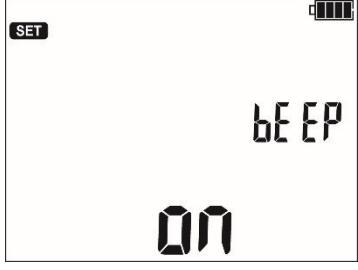
Включение (**ON**) и отключение (**OFF**) звуковых сигналов.
