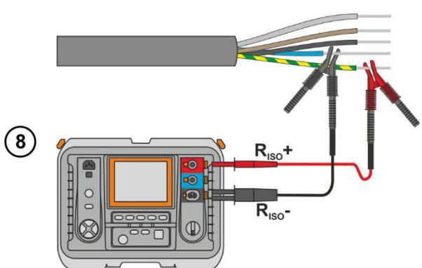
Подключите измерительные провода согласно рисунку.
