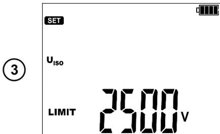
Окончательное напряжение измерения  $U_{iso}$  **LIMIT**.
