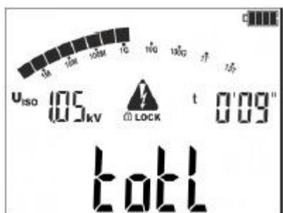
При первом этапе измеряется суммарное сопротивление изолятора  $R_{totl}$ .
