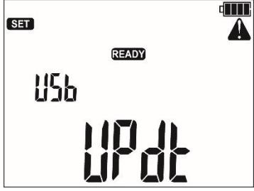
Обновление программного обеспечения.
