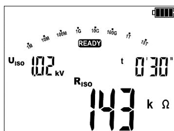
При пробое изоляции прибор не прерывает измерение, а продолжает его до истечения установленного времени.
