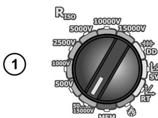
Установите поворотный переключатель режимов работы в одну из позиций **R<sub>Iso</sub>**, выберите измерительное напряжение (в положении **50...15000V** выбирается с шагом в 10 В).
