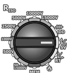
Установите поворотный переключатель выбора функций в положение **SV**.
