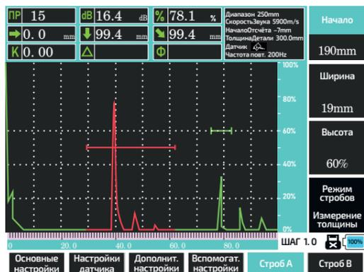
Рис. 33. Дифференциальное измерение толщины
