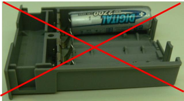
Аккумулятор установлен под некоторым углом
