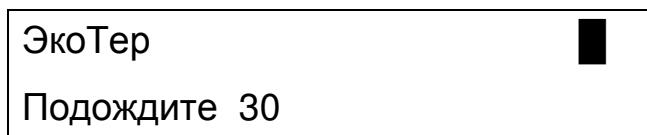
Цифра 30, означающая 30 секунд, начнет убывать. По истечении 30 с на индикаторе отобразится измеренное значение скорости воздушного потока:
