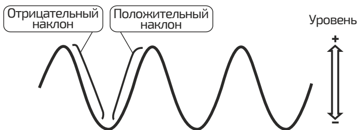
Рисунок 6. Иллюстрация полярности (фронтов) запуска синхронизации.
