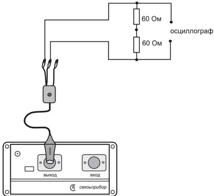
Используйте осциллограф для измерения сигнала на резисторе. На экране осциллографа должна наблюдаться осциллограмма, показанная на рисунке:
