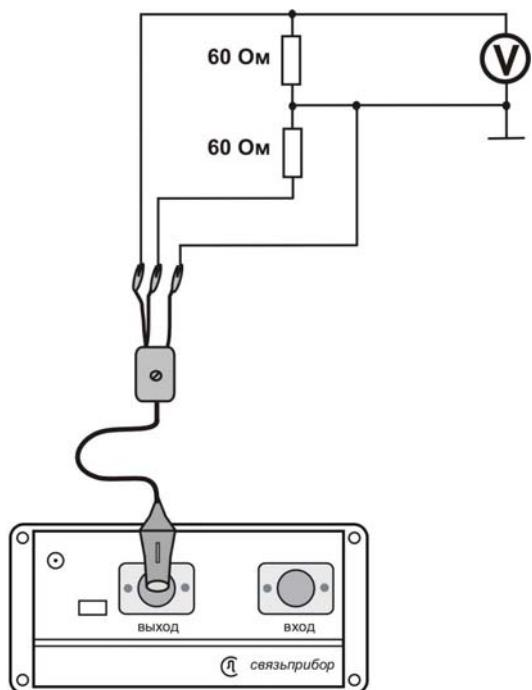
Используйте вольтметр для измерения уровня сигнала на любом из плеч нагрузки. **(Обязательно применение делителя напряжения ДН, входящего в комплект вольтметра).** Уровень плеч должен быть одинаковым и равным половине выходного уровня:  $0,97 \pm 0,06$  В.
