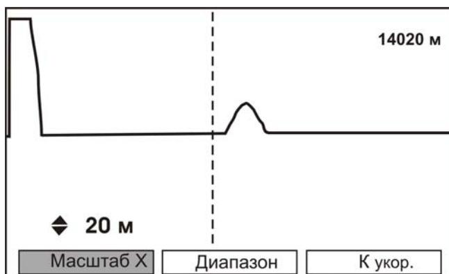
Корректное измерение расстояния проводится после ввода коэффициента укорочения. Нажмите кнопку «К укор.» и с помощью кнопок « $\uparrow$ », « $\downarrow$ » установите желаемое значение:
