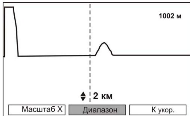
Прибор сам устанавливает оптимальную ширину импульса в зависимости от выбранного диапазона. Однако измеритель может изменять этот параметр для получения более четкой картинки. Для этого повторно нажмите кнопку «Диапазон» и с помощью кнопок «↑», «↓» выберете наиболее информативное значение. На малых расстояниях следует пользоваться короткими импульсами, а на больших – более длинными:
