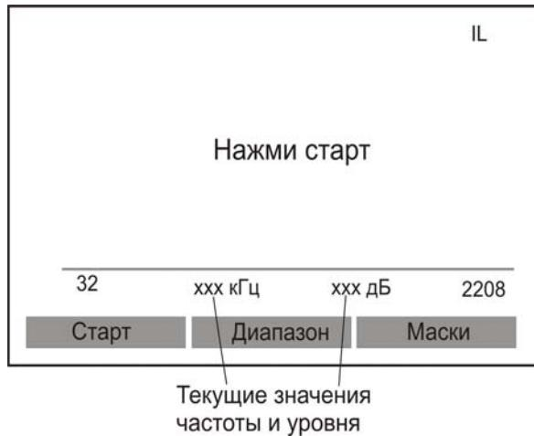
Измерение АЧХ проводится по заданному циклу частот. Измеритель может выбрать интервал 32-2208 кГц; 32-8192 кГц или 26-16384 кГц с помощью кнопки «Диапазон».
