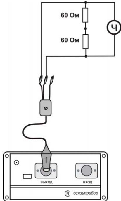
Включите режим «РЕФЛЕКТОМЕТР» в главном меню прибора. Нажав кнопку «ДОПОЛНИТЕЛЬНО», включите режим «КАЛИБРОВОЧНЫЕ МЕТКИ».
