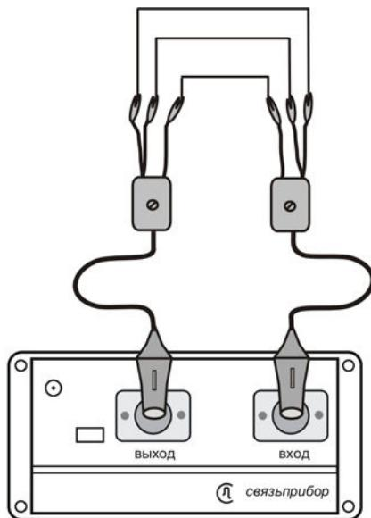
Измерения производятся для всех опорных частот основного списка в режиме узкополосного измерения уровня.
