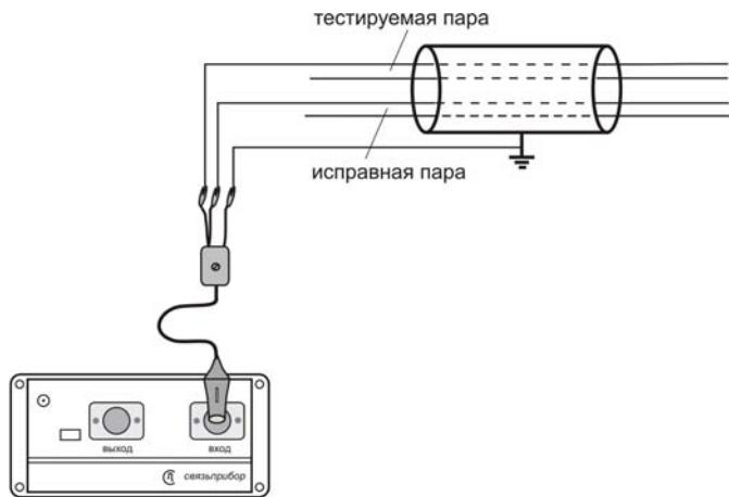
Отображаемая на экране разница отраженных сигналов позволяет точно определить расстояние до места, где пары отличаются друг от друга. Поскольку на экране показана разность сигналов, то по виду рефлекограммы нельзя судить о характере неисправности (обрыв или короткое замыкание). Для уточнения используйте режим общего входа.
