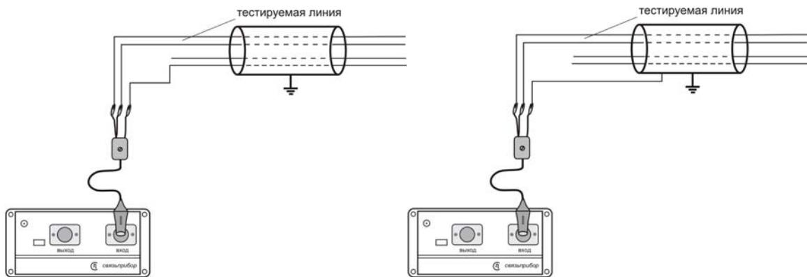
Если необходим режим сравнения жил из разных пар (функция двухканального рефлектометра), то ассиметричный вход следует подключить к двум жилам из разных пар, как показано на рисунке (предполагается, что одна из пар заведомо исправна):
