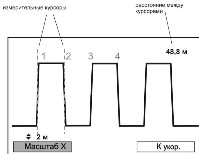
С помощью «горячих» кнопок «F3» и «F1» установите коэффициент укорочения 1,50 (по умолчанию) и масштаб по оси X (разрешение) 2 м.
