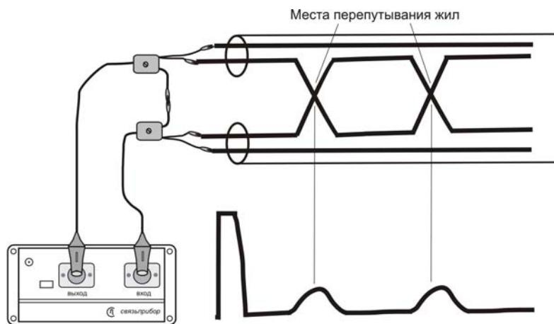
В режиме с ассиметричным входом зондирующий импульс подается одновременно в две жилы одной пары, а на экране отображается разница между отраженными сигналами. Такой режим позволяет точно определить расстояние до места нарушения симметрии пары (повреждения одной из жил пары). Для работы используйте одну из представленных схем:
