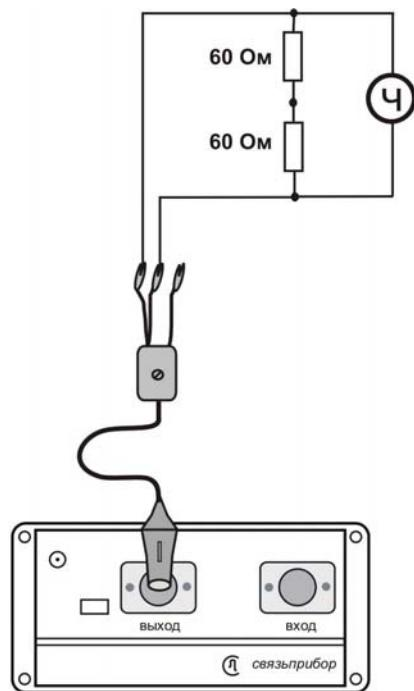
Измерения производятся для частот 16384.00 кГц и 32.00 кГц в режиме узкополосного измерения уровня. Полученные значения должны соответствовать заявленным в разделе технические характеристики настоящего руководства.
