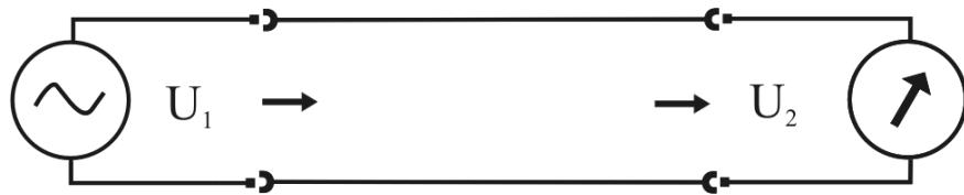
Рабочее затухание в линии IL (Insertion Loss), [дБ] является интегральной характеристикой, отражающей затухание сигнала, вызванное всей совокупностью факторов:
