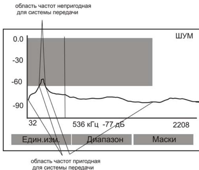
Для выбранного типа системы передачи пригодна та область частот, которая не попадает в выделенную часть экрана. Попадание частоты в выделенную область свидетельствует о том, что уровень шума превышает нормативный порог.
