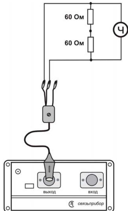
Включите режим «РЕФЛЕКТОМЕТР» в главном меню прибора. Нажав кнопку «ДОПОЛНИТЕЛЬНО», включите режим «КАЛИБРОВОЧНЫЕ МЕТКИ». Этот режим служит для проведения поверки (калибровки) рефлектометра.
