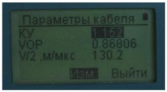
Анализируя рефлектограмму можно определить замкнут или разомкнут другой конец кабеля и при помощи двух специальных вертикальных подвижных курсоров измерить длину кабеля, сохранить рефлектограмму в памяти, сравнить ее с ранее измеренной и т.д.
