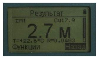
После этого измерение длины кабеля (провода) прибор выполнит автоматически и высветит длину кабеля крупными цифрами на экране прибора.
