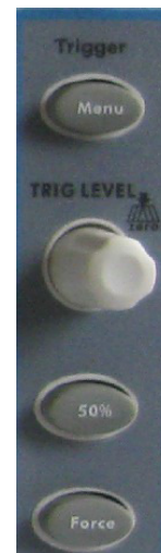
Рисунок 4.14. Поле управления системой запуска
