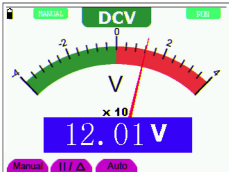
Рисунок 33. Переключение между автоматическим и ручным выбором предела измерения
