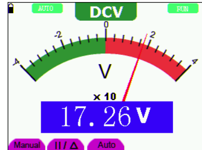
Рисунок 25. Измерение постоянного напряжения
