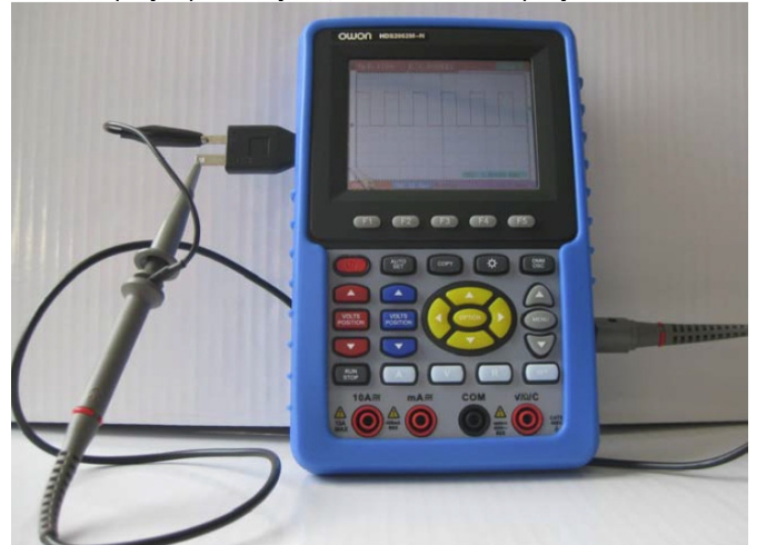
Рисунок 3. Подсоединение тестового прямоугольного сигнала
