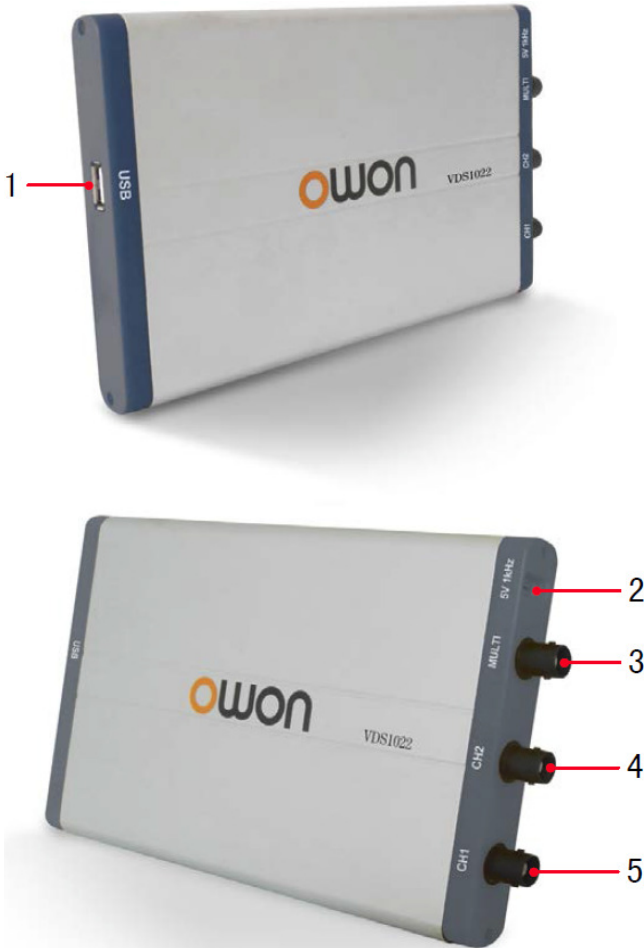
Рисунок: Порты осциллографа на примере модели VDS1022
