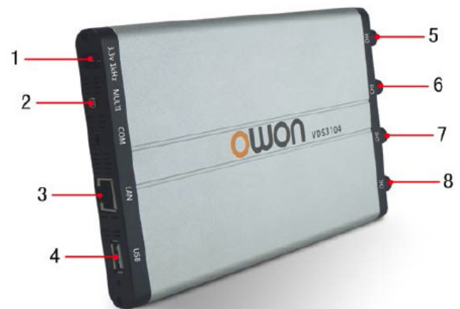
Рисунок: Порты осциллографа на примере модели VDS3104
