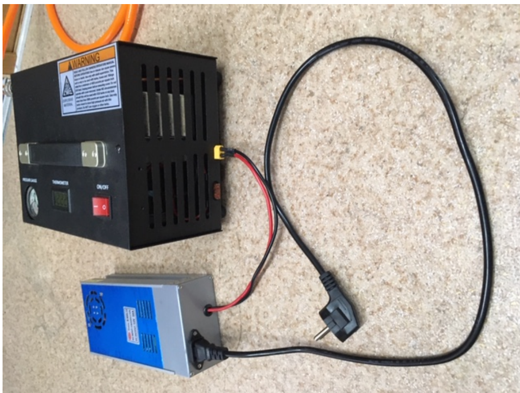
Рис. 4. Питание компрессора от сети 220 вольт
