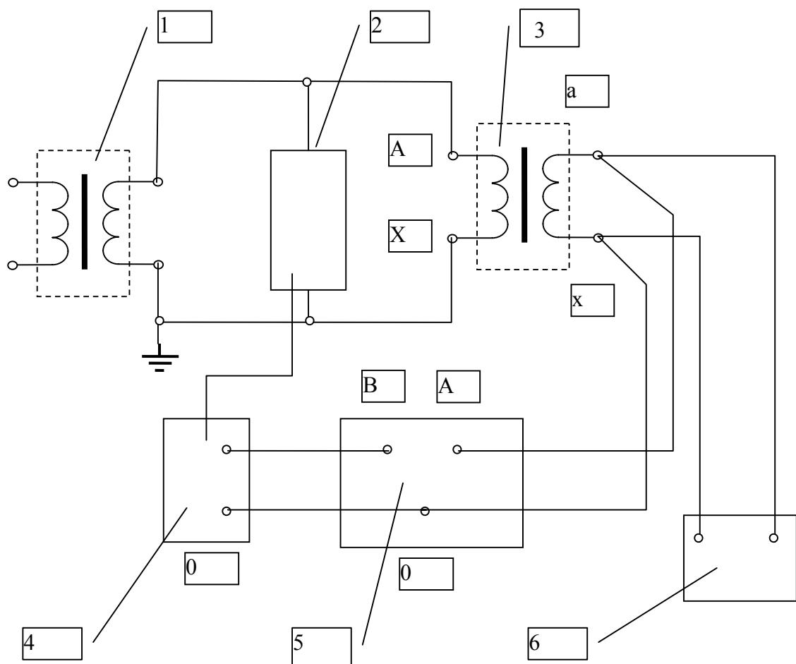
1 - испытательный трансформатор; 2 – конденсатор КГИ из состава преобразователя ПВЕ;
