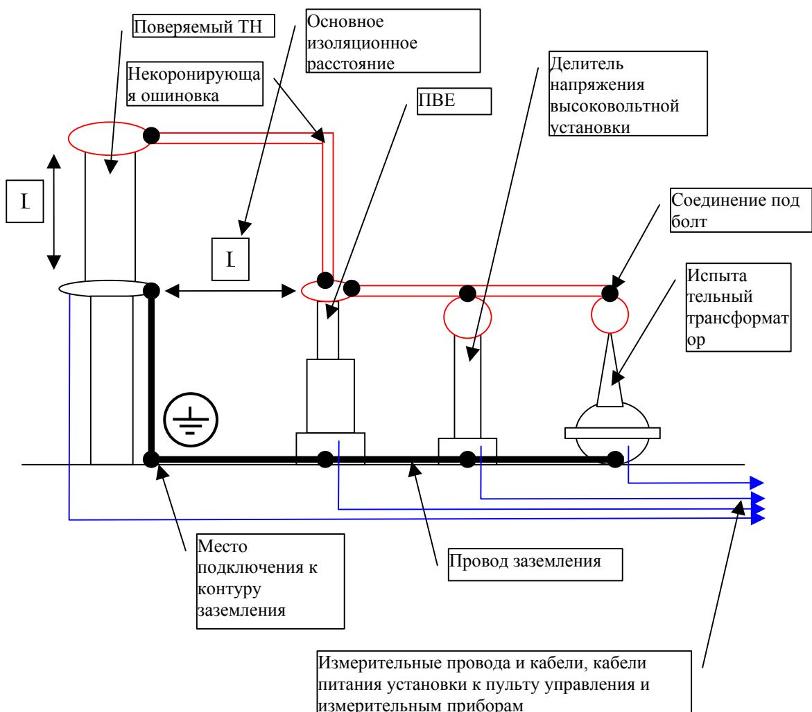
Электрическая схема соединений при поверке трансформатора напряжения
