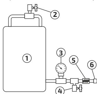
Подсоедините к насосу всасывающий и обратный шланги. На всасывающий шланг установите фильтры грубой и тонкой очистки (если жидкость для испытания чистая без взвеси и осадка - достаточно только фильтра тонкой очистки). Опустите их в ёмкость с жидкостью для испытаний.
