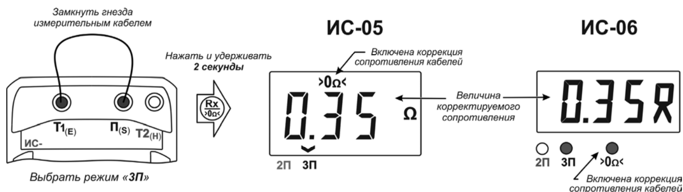
Рисунок 3 – Коррекция сопротивления измерительного кабеля (3П)
