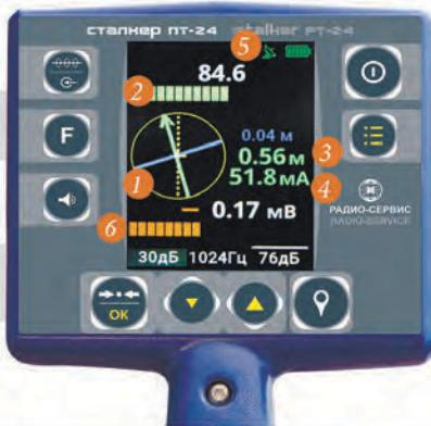
Указатель планового положения оси коммуникации «КОМПАС» с отображением 2-х коммуникаций
