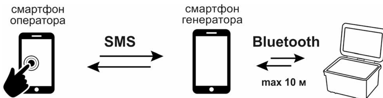
Рисунок 2.8 – Организация дистанционного управления генератором
