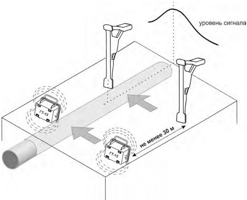
Рисунок 4.4.2.2 – Обследование участков местности с помощью ГТ-15
