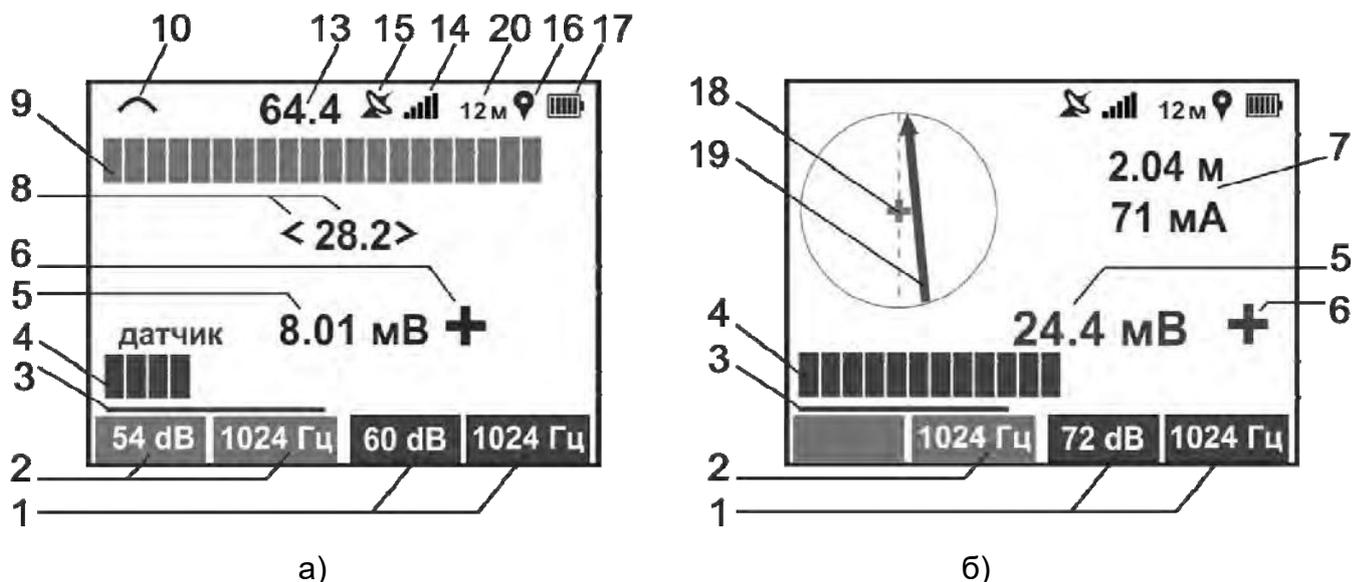
Рисунок 3.3 – Индикация приемника в режиме «ТРАССА-ДАТЧИК»
