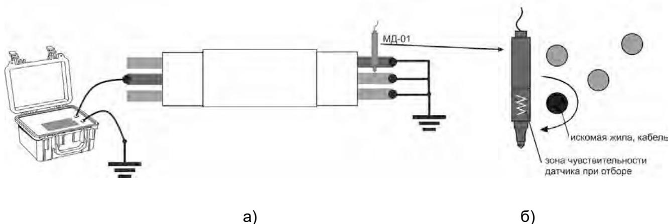
Рисунок 5.4.1 – Схема подключения при отборе жил кабеля
