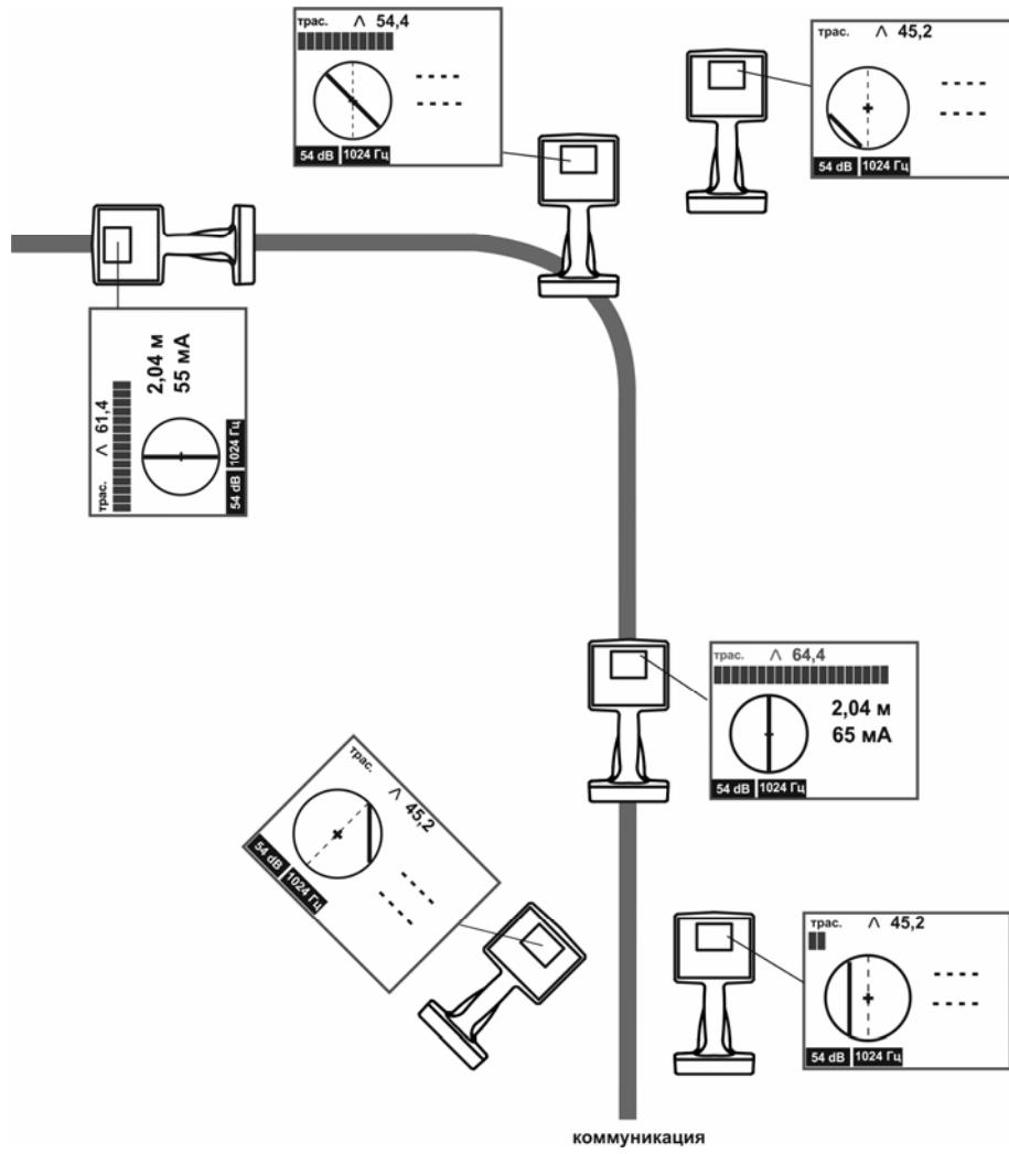
Рисунок 4.2.3 – Поиск с включенной функцией «КОМПАС»
