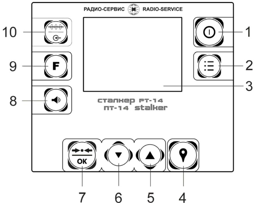
Рисунок 1.4.2 - Передняя панель приёмника
