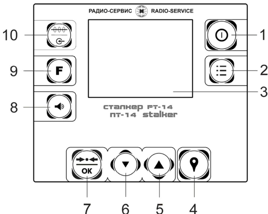
Рисунок 1.4.2 - Передняя панель приёмника
