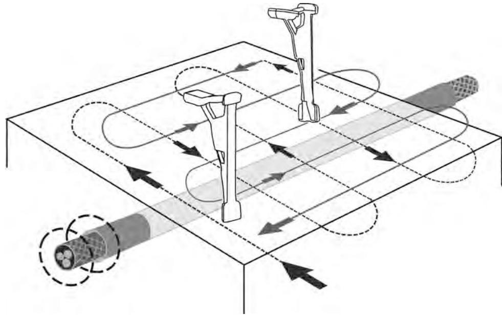
Рисунок 4.4.1 – Обследование участков местности без генератора
