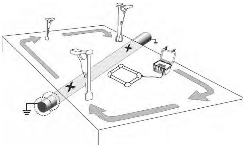
Рисунок 4.4.2.1 – Обследование участков местности с использованием рамки РП-02
