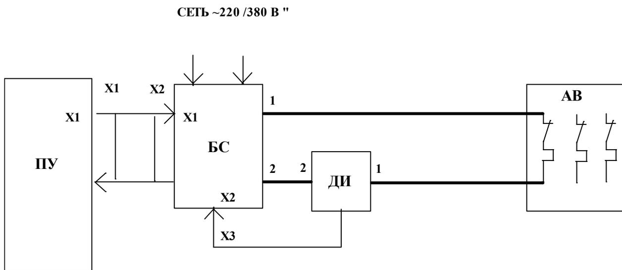
Рис. П1.1 Функциональная схема Комплекта с испытуемым АВ
