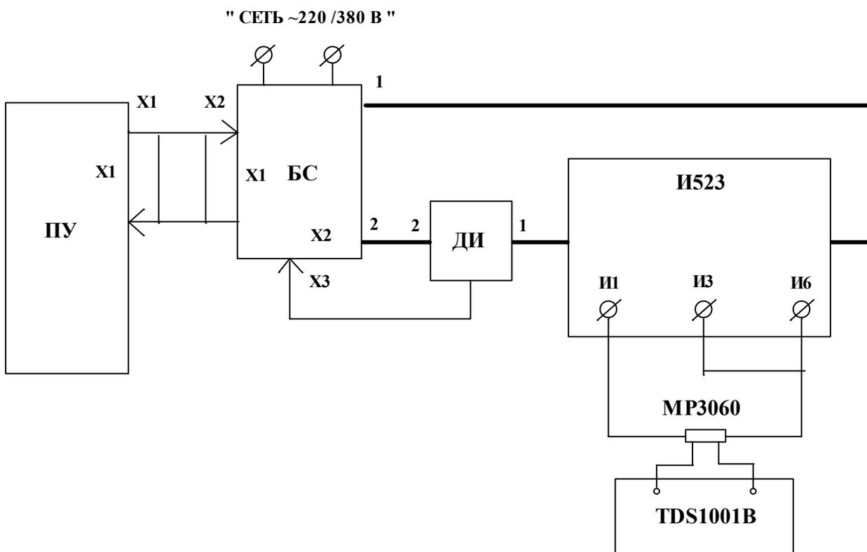
Рис.П2.2 Схема определения приведенной погрешности измерения силы тока
