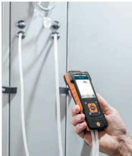
Модель testo 440 dP, включающая сенсор дифференциального давления, позволит вам своевременно принять решение о замене фильтров систем кондиционирования, так, чтобы никакое загрязнение снаружи не попало в воздух помещения
