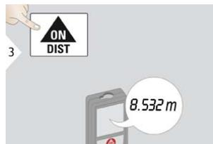
**i** Целевые поверхности: ошибки при измерениях могут возникнуть в случае выполнения измерений до таких поверхностей как бесцветные жидкости, стекло, пенопласт, проницаемые поверхности или при наведении на очень блестящие поверхности. При наведении на темные поверхности время измерения увеличивается.
