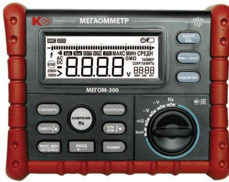
Цифровые мегаомметры МЕГОМ-300 торговой марки КС® предназначены для измерения электрического сопротивления изоляции постоянному току, напряжения постоянного и переменного тока, а также диагностики состояния изоляции электрических цепей, не находящихся под напряжением.
