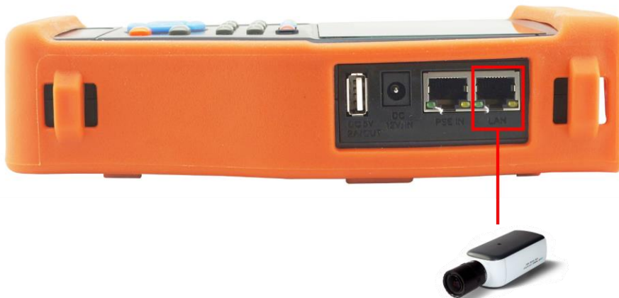
Рис. 5 Подключение IP-видеокамеры к тестеру
