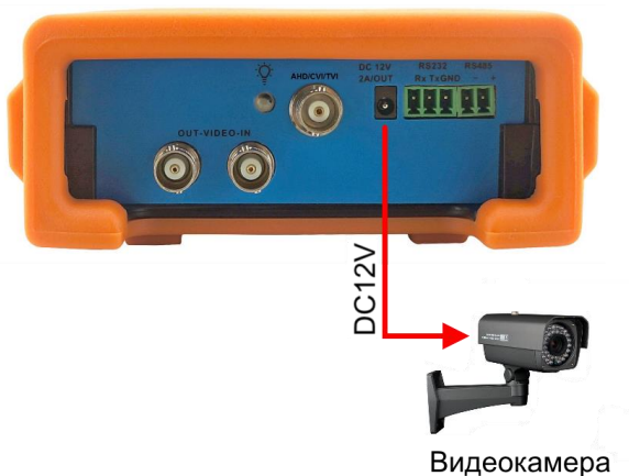
Рис. 7 Подключение питания к IP-видеокамере
