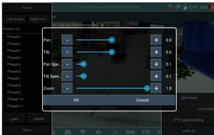
Рис. 47 Настройки горизонтальной и вертикальной скорости PTZ
