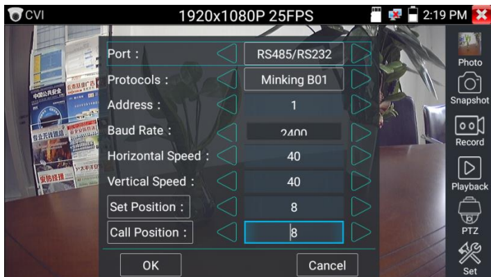
Рис.80 Управление PTZ CVI видеокamerой по интерфейсу RS232/485
