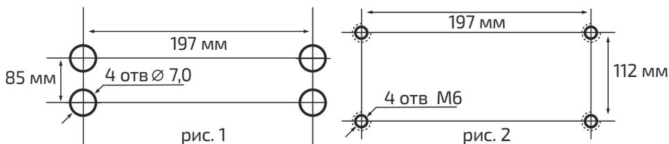
● Просверлите четыре отверстия (при необходимости нарежьте резьбу) и установите насос на 4 амортизационные стойки (короткая резьба должна быть со стороны насоса).
